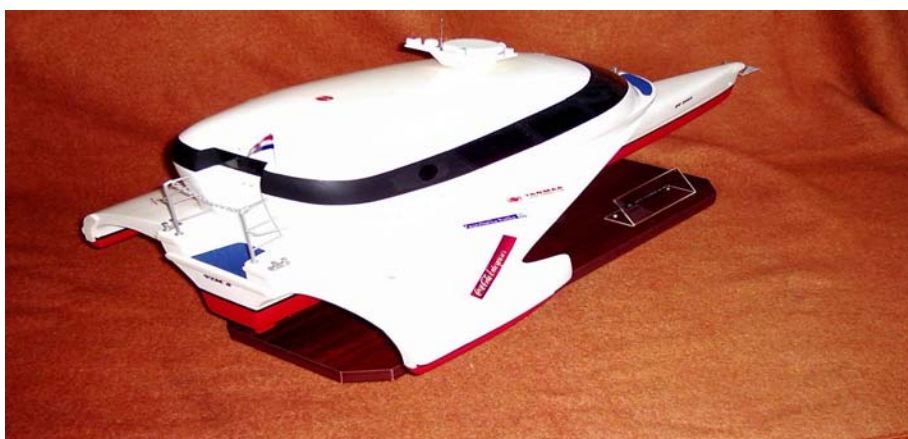
Slika 10 “ TRILLENNIUM 8000”, morski automobil, idejno rješenje G. Čurin, dipl. inž. brod. iz Splita, brzine 22 – 25 uzlova, manji trotrupac
