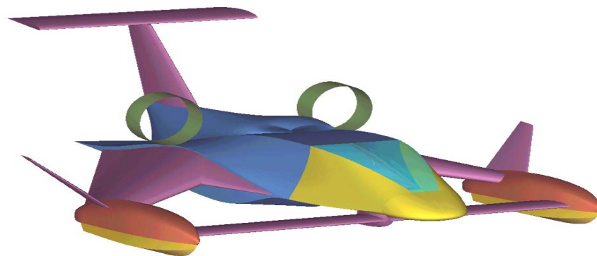
Slika 11 « BRACERA II» - plovilo za prijevoz 20 putnika, idejno rješenje D. Marasović, dipl.ing.zrak. iz Splita, brzina oko 120 uzlova, ekranoplov
