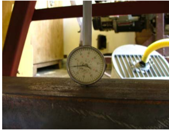
Fig. 17. Deflection of the bottom plate Slika 17. Progibi podne ploče
