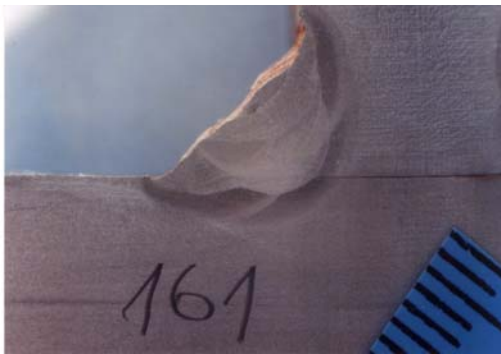
Slika 4. Kutni podvodni zavar Fig. 4 Underwater fillet weld
