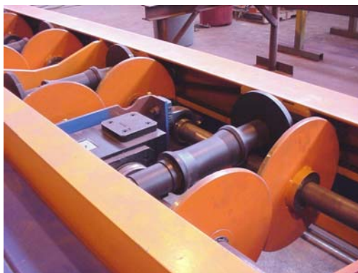
Fig. 5. Integrated Transport Rollers Slika 5. Integrirani prijenosni valjci
