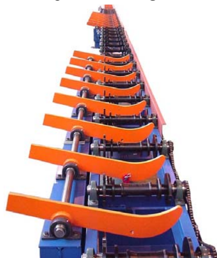
Fig. 6. Integrated Kick-out Arms Slika 6. Integrirane ruke za izbacivanje
