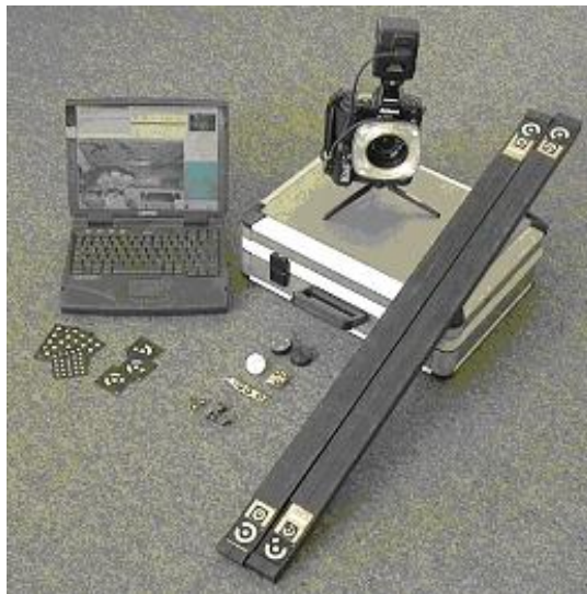
Slika 2. Fotogrametrijski sustav TRITOP (GOM mbH, Njemačka)
