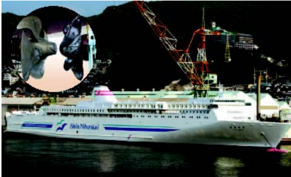
Slika 23 RoPax prijevoznica opremljena CRP Azipodom 24MW+17,6MW
