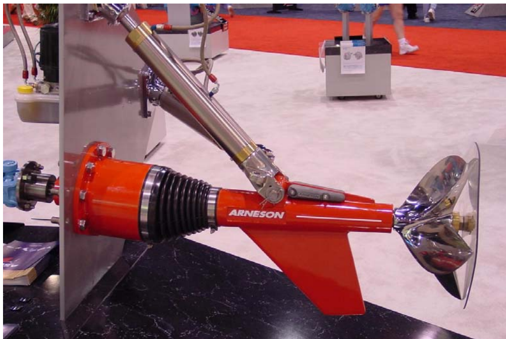
Slika 3 Arneson prigon s djelomično uronjenim vijkom na kraju horizontalno i vertikalno pomične osovine. Crnim gumenim posuvratkom (manšetom) zaštićen je kardanski zglob.
