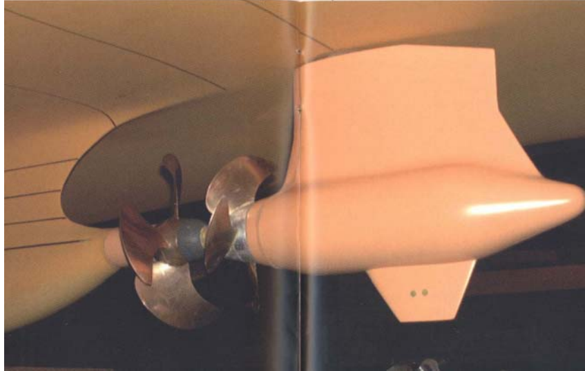
Slika 24 Ispitivanje hibridnog propulzora u kavitacijskom tunelu
