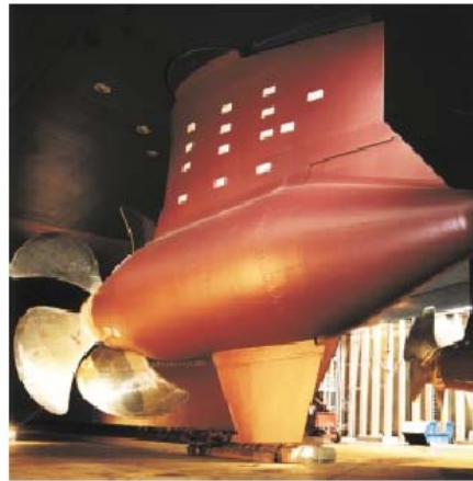
Slika 15 ABB Azipod® propulzor; glavni dijelovi Fig. 15 ABB Azipod®; principal parts
