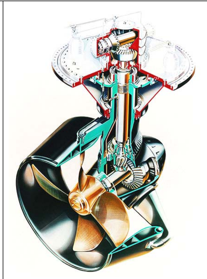
Slika 11 Usmjerivi, dizelskim motorom gonjeni porivnik s porivnim vijkom u sapnici - SRP Fig. 11 Azimuthing thruster, diesel driven with pushing propeller in the nozzle
