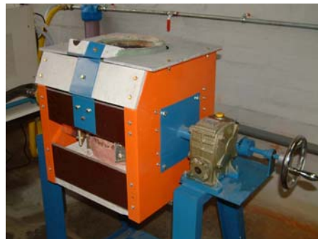
INDUKCIJSKA PEĆ KAPACITETA 30 kg ČELIKA
