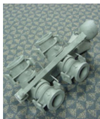
Odljevci s uljevnim sustavom (grozd)
