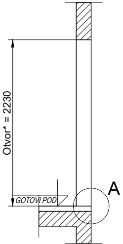
Otvor za vrata 1:50 * = od razine gotovog poda (GP) * = u stanici 3
