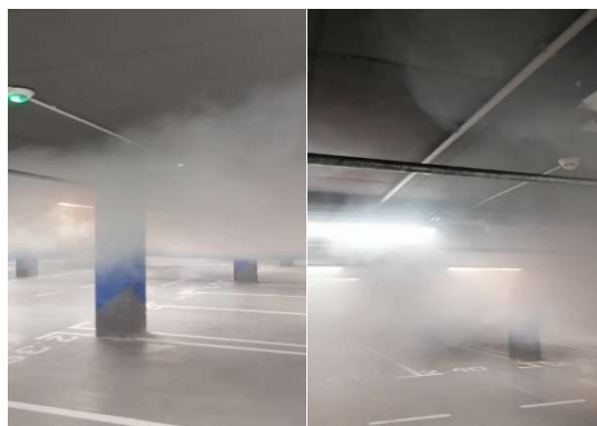
Slika 42. Prikaz smanjenja vidljivosti uslijed turbulentnog kretanja dima – podzemna garaža Stari Grad, Sarajevo
