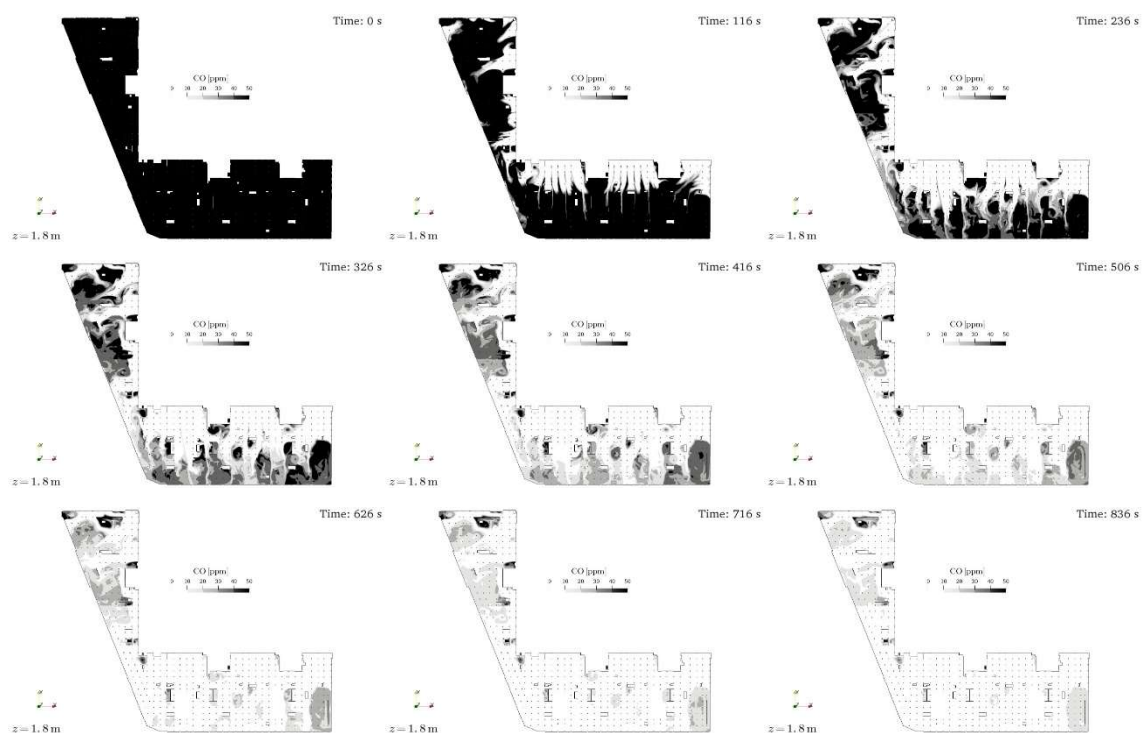
Slika 64. Polja nepokretnog zraka i koncentracija CO - podzemna garaža Colchester
