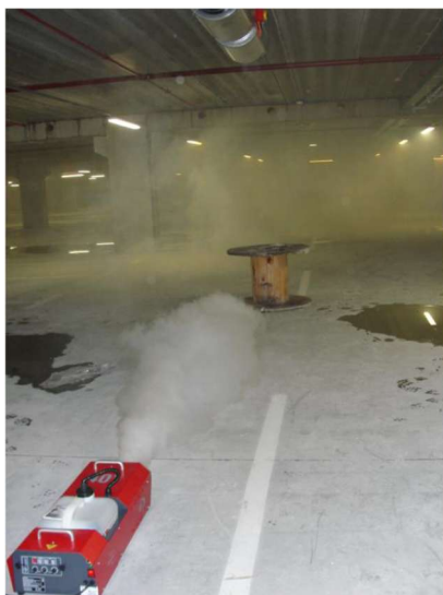
Slika 34. Ispitivanje dimom generatorom dima i magle - podzemna garaža Stožice, Ljubljana
