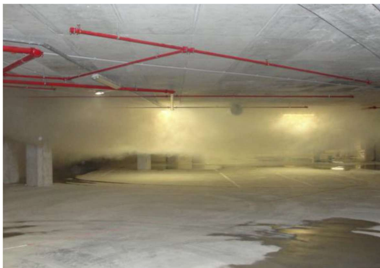
Slika 35. Kretanje hladnog dima tokom ispitivanja - podzemna garaža Stožice, Ljubljana
