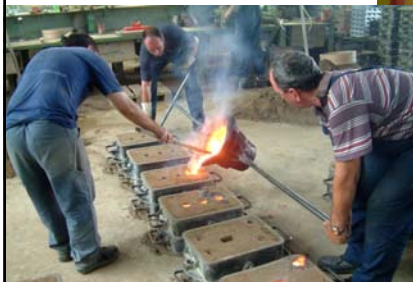
LJEVAČKI LONAC ZA RUČNO PRENOŠENJE I ULIJEVANJE
