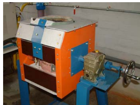
INDUKCIJSKA PEĆ KAPACITETA 30 kg ČELIKA
