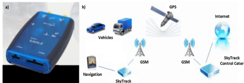
STM telemetrijski modul za praćenje vozila i SkyTrack sustav praćenja tvrtke Artronic, Zagreb
