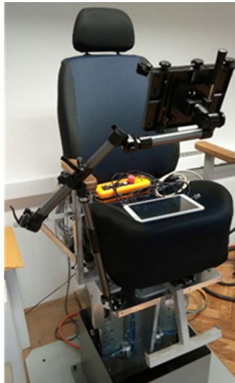
Laboratorijski postav za ispitivanje udobnosti vožnje (© FSB-ACG)
