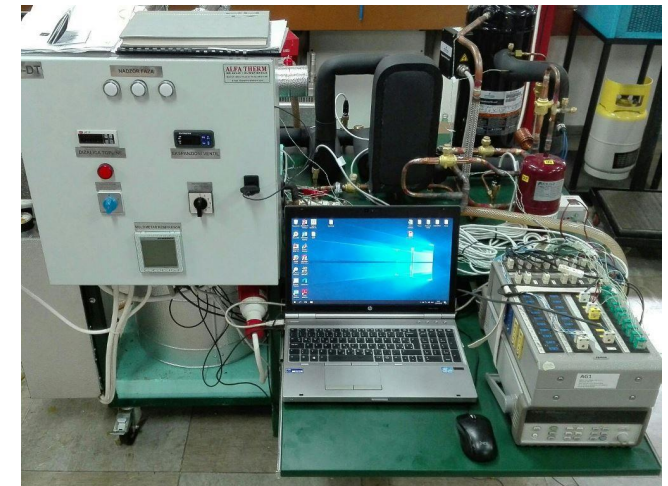
Upravljački sustav s akvizicijskom opremom
