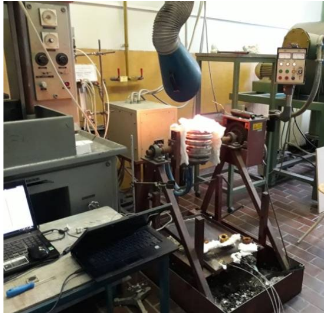
Slika 63. Taljenje materijala u indukcijskoj peći
