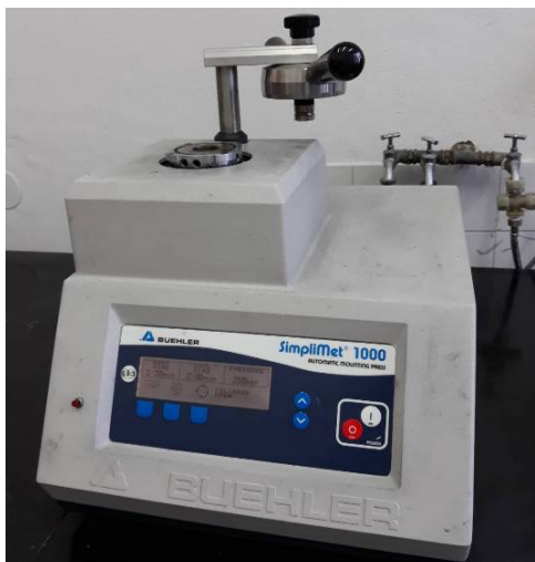
Slika 72. Uređaj za vruće ulijevanje uzoraka Buehler SimpliMet® 1000
