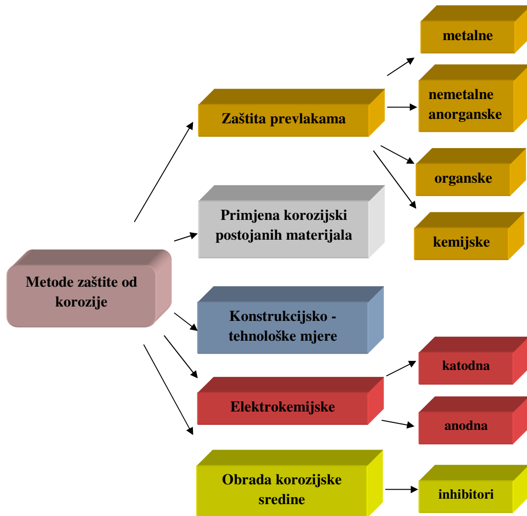
Slika 58. Shematski prikaz metoda zaštite od korozije
