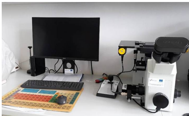
Slika 77. Invertni metalografski mikroskop Olympus GX 71 s digitalnom kamerom DP70
