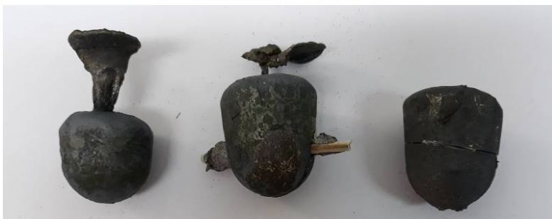
Slika 66. Pretaljeni uzorci alatnih čelika nakon provedene jednostavne toplinske analize
