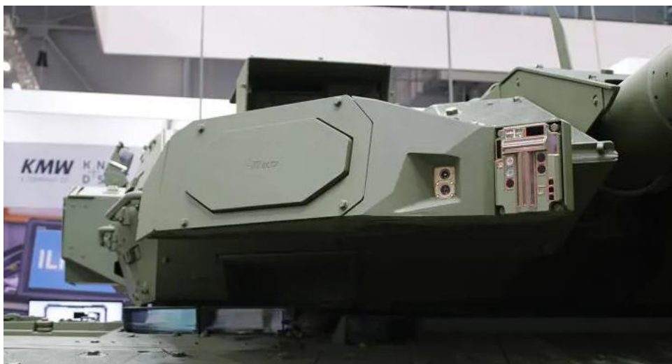
Slika 24. Radar aktivnog sustava zaštite Trophy se nalazi na svakom kutu kupole [1] Slikoviti prikaz rada aktivnog sustava zaštite tipa Trophy je prikazan na slici (Slika 25).
