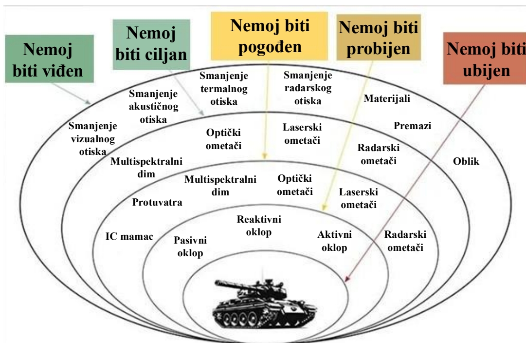
Slika 20. Slojevitost zaštite borbenog oklopnog vozila [60]
