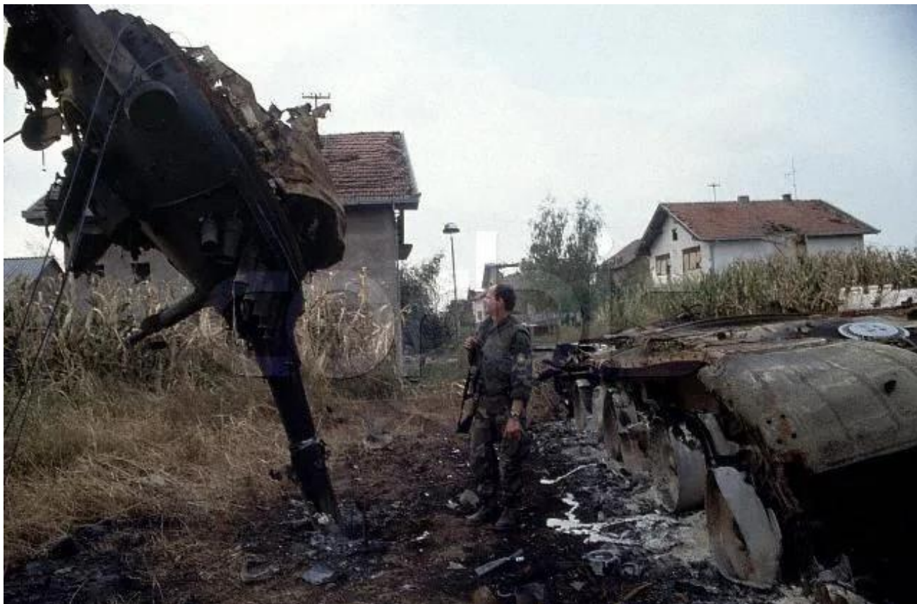
Slika 13. Primjer posljedice neadekvatnog smještaja streljiva u tenku – uništeni M-84 [39] 4.2. Odabir kriterija za nabavu
