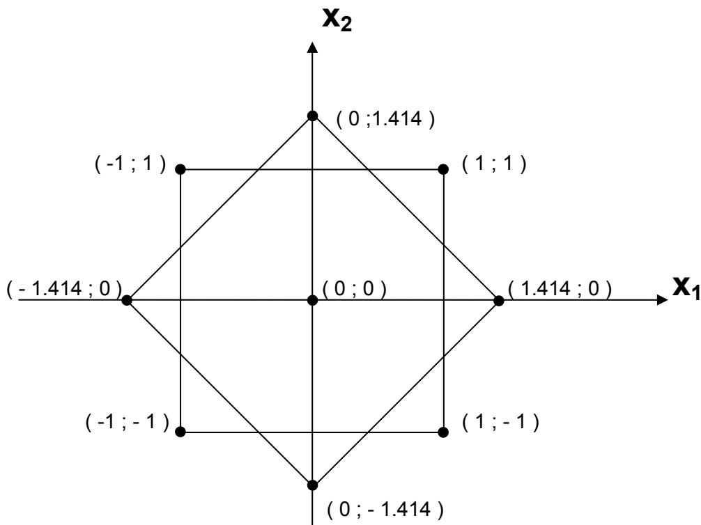
**SLIKA 11 :** Grafički prikaz centralno-kompozitnog rotatabilnog plana .
