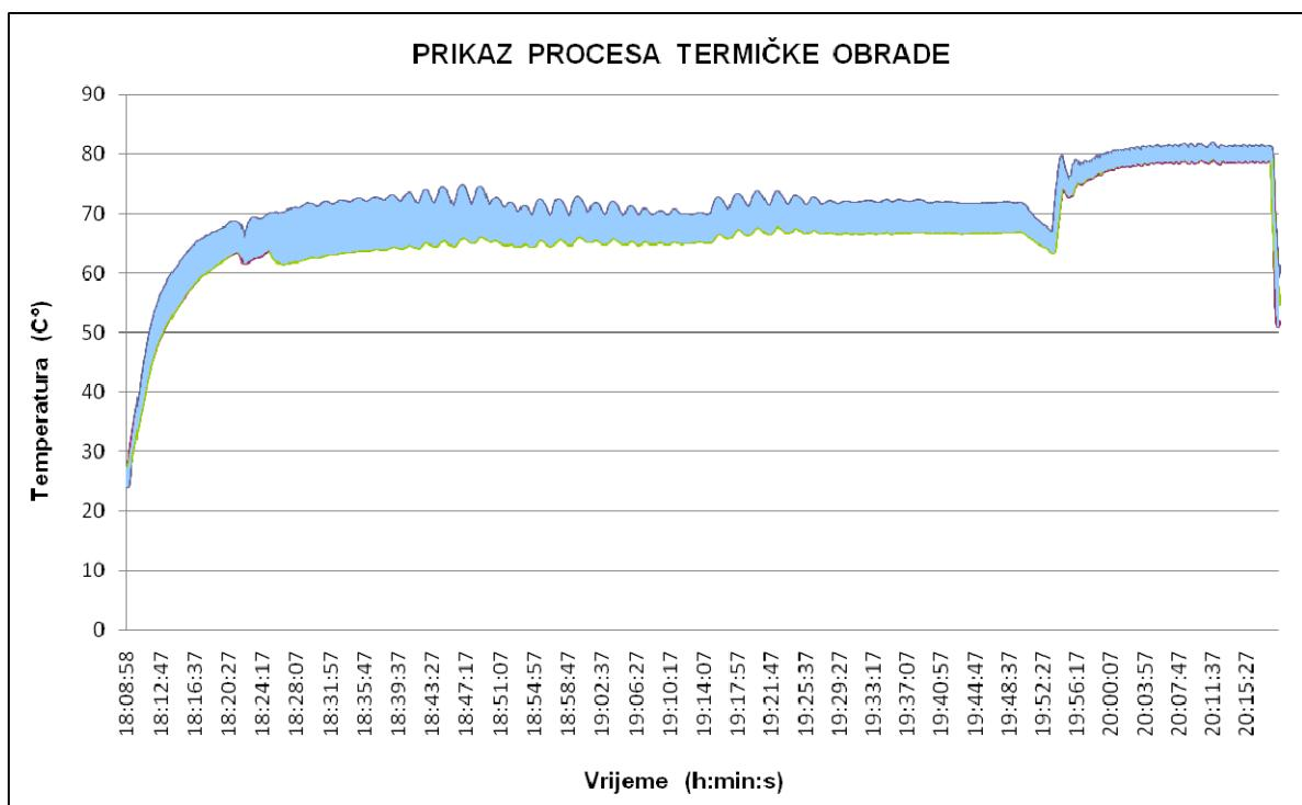
**SLIKA 25 :** Prikaz procesa termičke obrade proizvoda "Kranjska kobasica  $\Phi 32\text{ mm}$ " ( 15 mjernih temperaturnih osjetila ).
