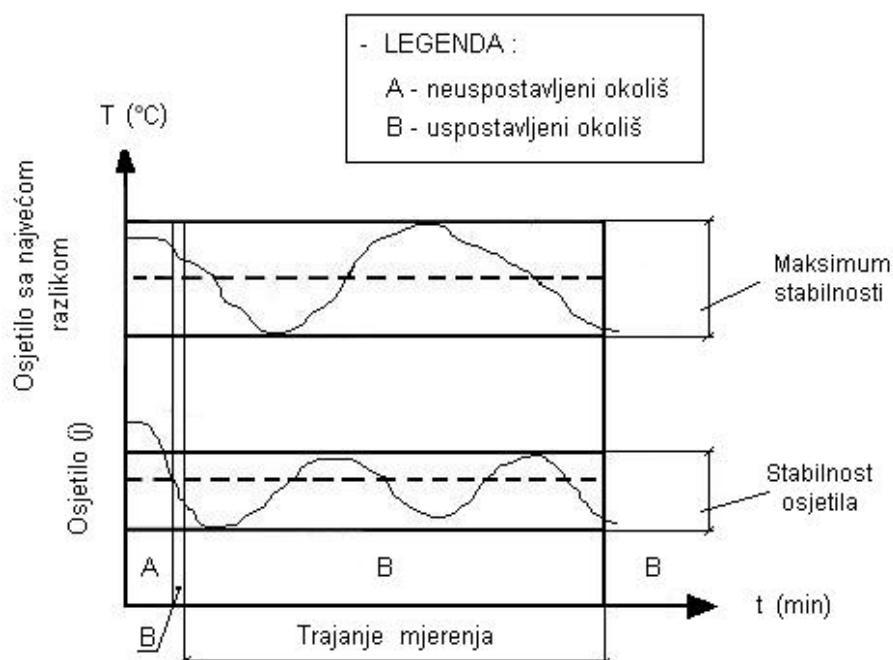
**SLIKA 29 :** Stabilnost i maksimum stabilnosti točke unutar radnog volumena komore.
