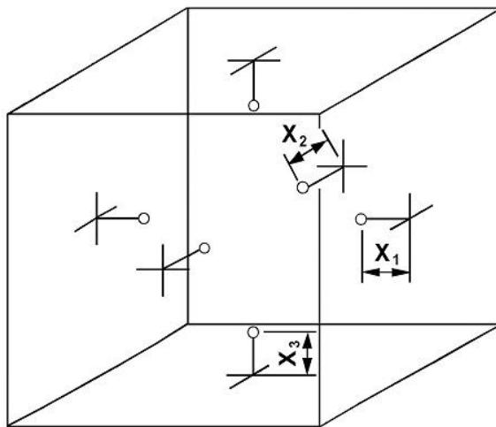
**SLIKA 20 :** Smještaj minimalnog broja dodatnih temperaturnih osjetila za termostatičke komore volumena preko 2000 lit. (velika komora).
