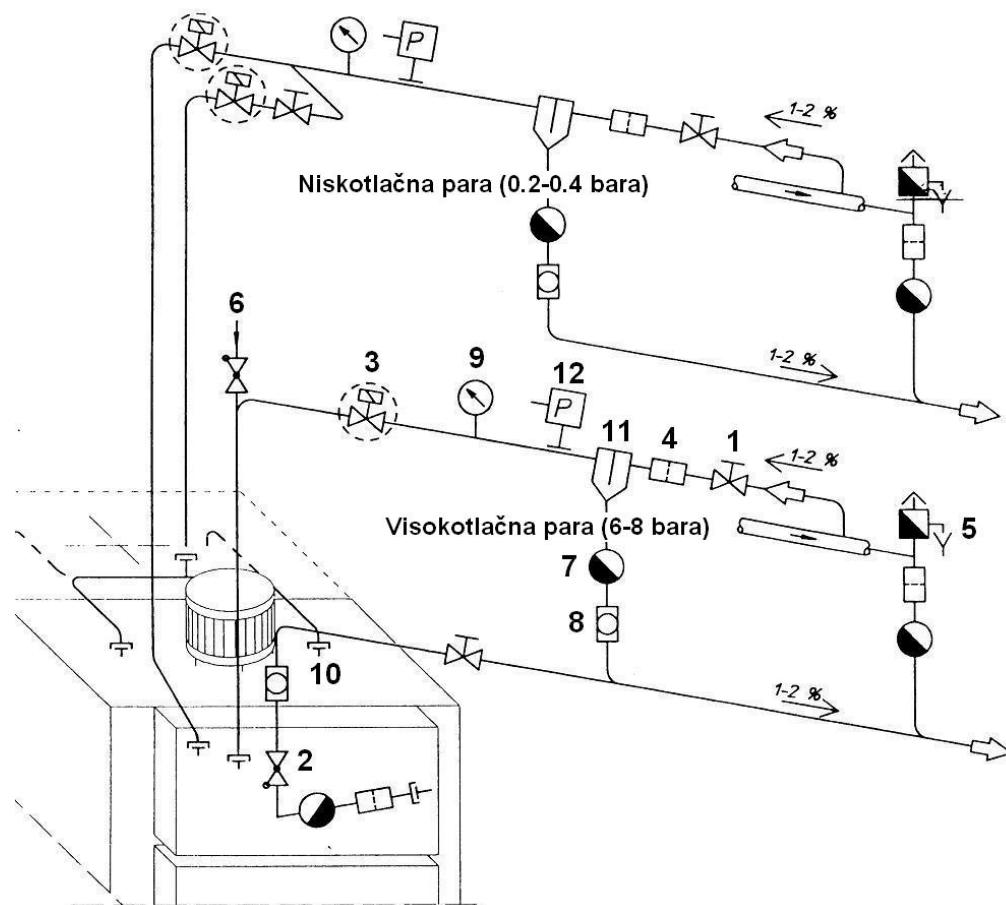
**SLIKA 2 :** Instalacija glavnog radnog medija–tehnološka suhozasićena para.
