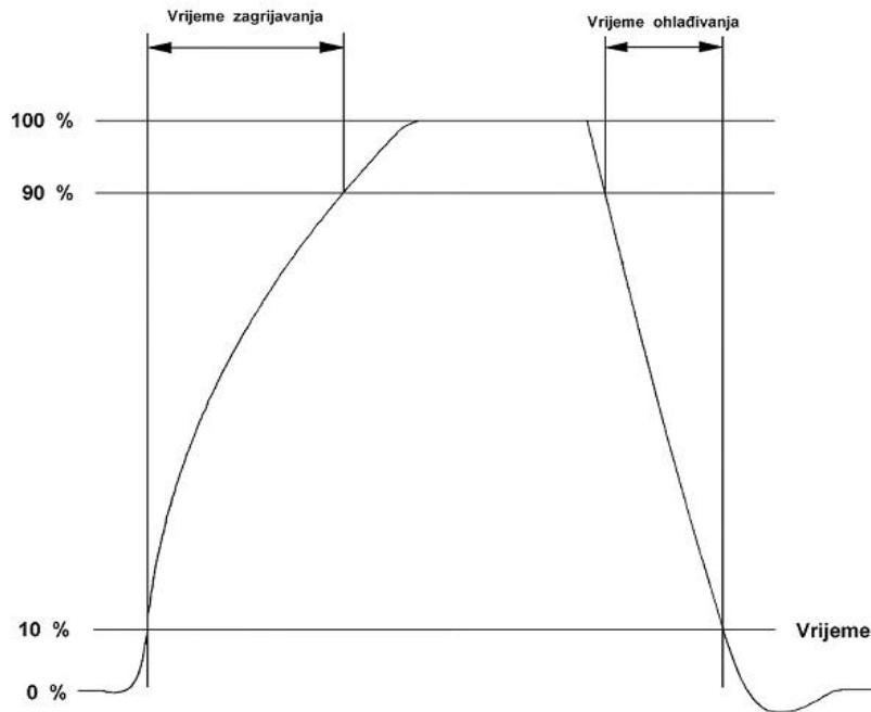
**SLIKA 21 :** Udio temperaturne promjene za procese zagrijavanja i hlađenja unutar termostatičke ispitne komore.
