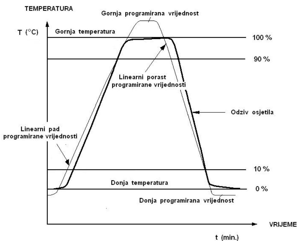
**SLIKA 34 :** Promjenjivost kontrolne temperature u radnom volumenu ispitne komore .
