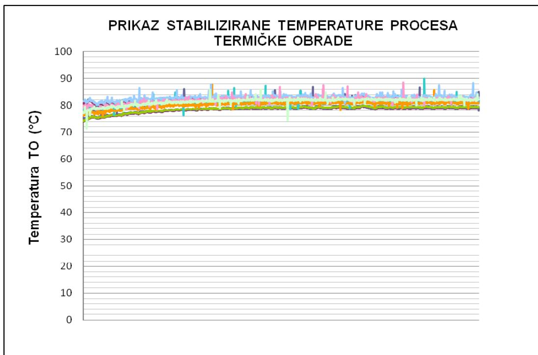
**SLIKA 28 :** Prikaz stabilizirane temperature procesa termičke obrade ( $T_{TO}$ ) s odstupanjem vrijednosti temperature ( $T_{TO}$ ) od  $+/- 0,5 \text{ } ^{\circ}\text{C}$ .
