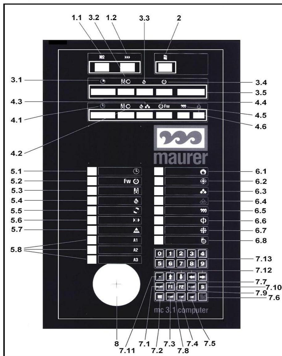
**SLIKA 3 :** Upravljačka ploča centralnog računalno-upravljačkog sistema MC-3.1.
