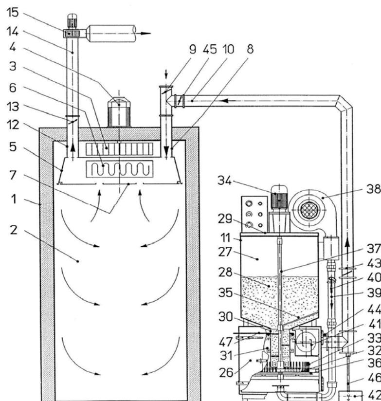
**SLIKA 1 :** Komora za termičku obradu polutrajnih mesnih proizvoda ,
