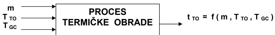
**SLIKA 15 :** Ulazni i izlazni parametri za trofaktorski eksperiment .
