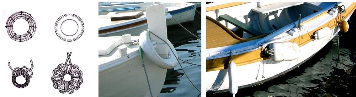
**Slika 23** Bokoštitnice: a.) starinske- izrađene od konopa; b.) automobilska guma na pramcu i c.) suvremene- gradene iz plastičnog materijala
