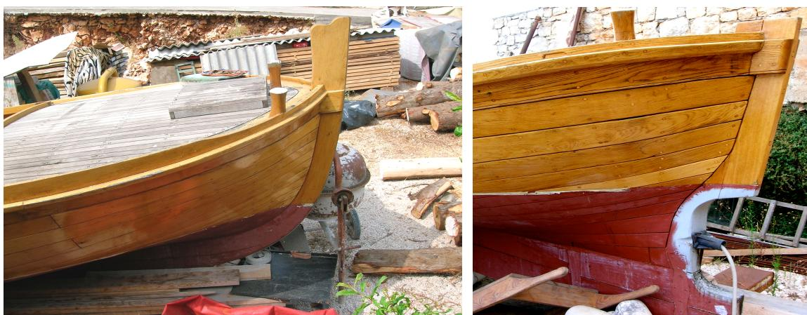
**Slika 21** Pramac i kрма korčulanske ribarice ( drveni čepovi na otvorima za prolaz čavala, ležaj osovine vijka, konstrukcijska vodna linija („peškaj“), „prva ruka“ laka i boje protiv obrastanja - „koperpajna“)
