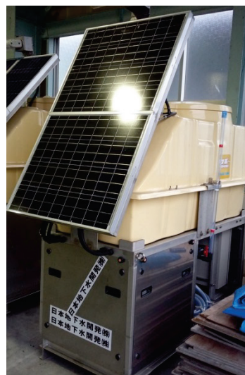
Solarni sustav za odleđivanje proizveden u JGD
