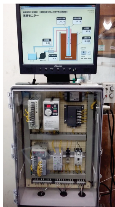
Mjerna linija za ispitivanje toplinskih svojstava ispune bušotine
