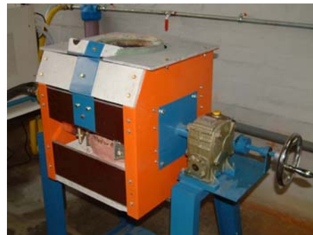
INDUKCIJSKA PEĆ KAPACITETA 30 kg ČELIKA
