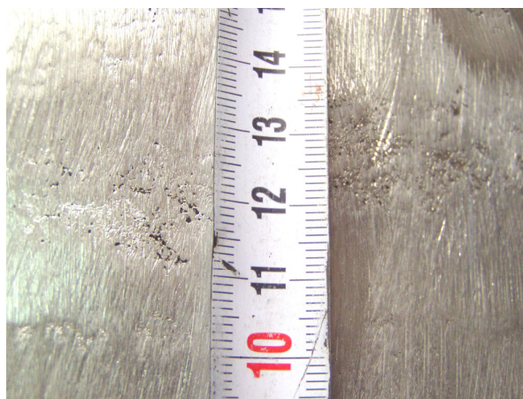
Slika 6 - 8: Poroznost na dijelu površine uzorka torusa
