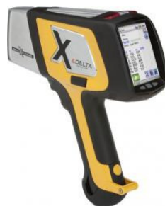
Slika 5 - 1: Prijenosni XRF uređaj Innov-X DELTA
