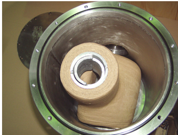
Slika 6 - 17: Umetnut uzorak 3 u posudu prije zatvaranja i vakuumiranja
