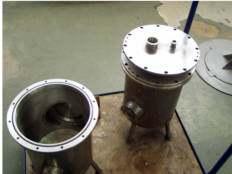
Slika 6 - 4: Vakuumstalne posude za provedbu pokusa
