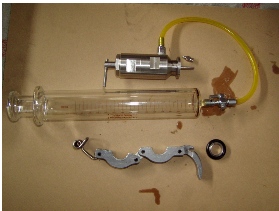
Slika 3 - 2: Pribor za uzimanje uzoraka transformatorskog ulja
