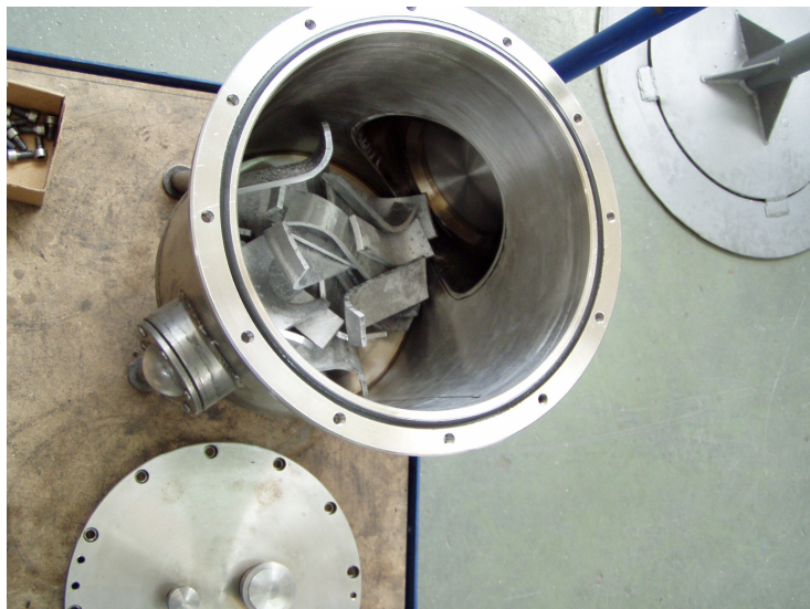
Slika 6 - 10: Posuda sa uzorkom 2 (materijal torusa) prije zatvaranja
