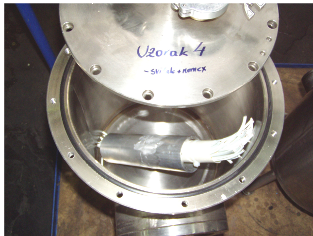
Slika 6 - 18: Umetnut Uzorak 4 u posudu prije zatvaranja i vakuumiranja
