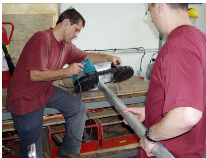
Slika 6 - 5: Izdvajanje područja zavarenog spoja cijev-torus
