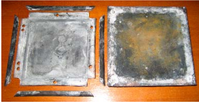
Slika 6.3. Kalup (147x147x21 mm)
