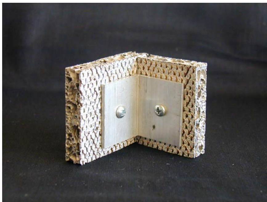
Slika 3.36. i Slika 3.37. Primjeri rastavljivog spajanja metalnih pjena, [16]
