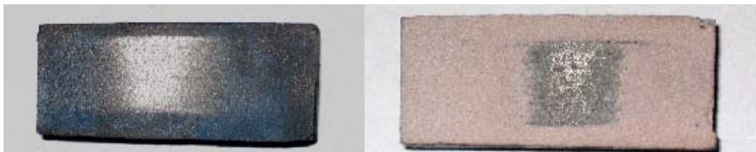
Slika 6.12. Trag od ispitivanja na uzorcima na uređaju "suhi pijesak/gumeni kotač"
