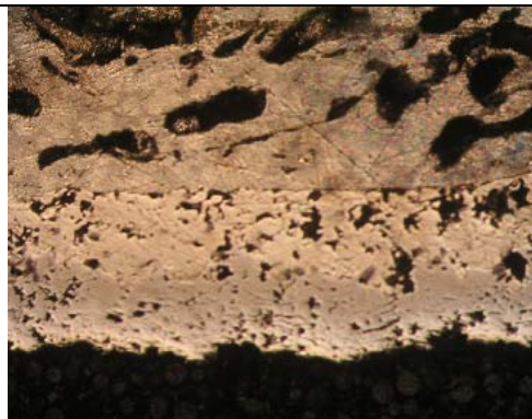
Mikrostruktura sloja METACERAM 28095 na uzorcima Al pjene, nenagriženo, povećanje 100:1
