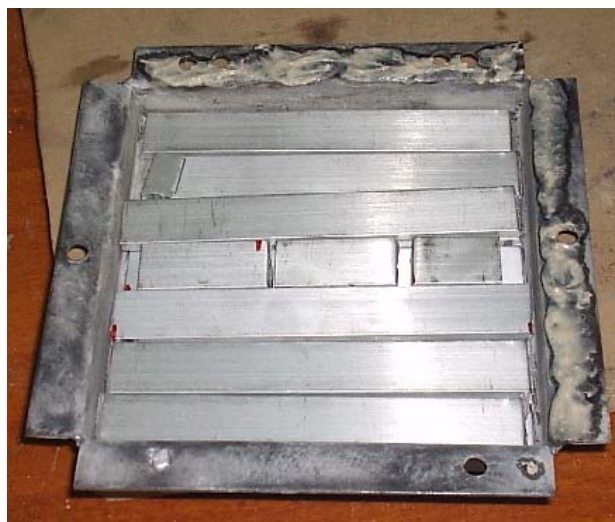
Slika 6.2. Punjenje kalupa prekursorom
