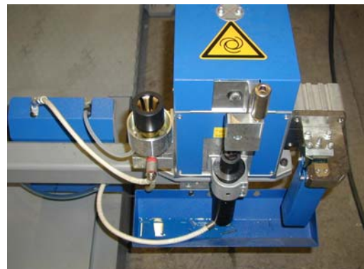
Gore: Izvori struje za zavarivanje sa „ARC“ senzorom Dolje: Sustav za čišćenje sapnice i rezanje žice
