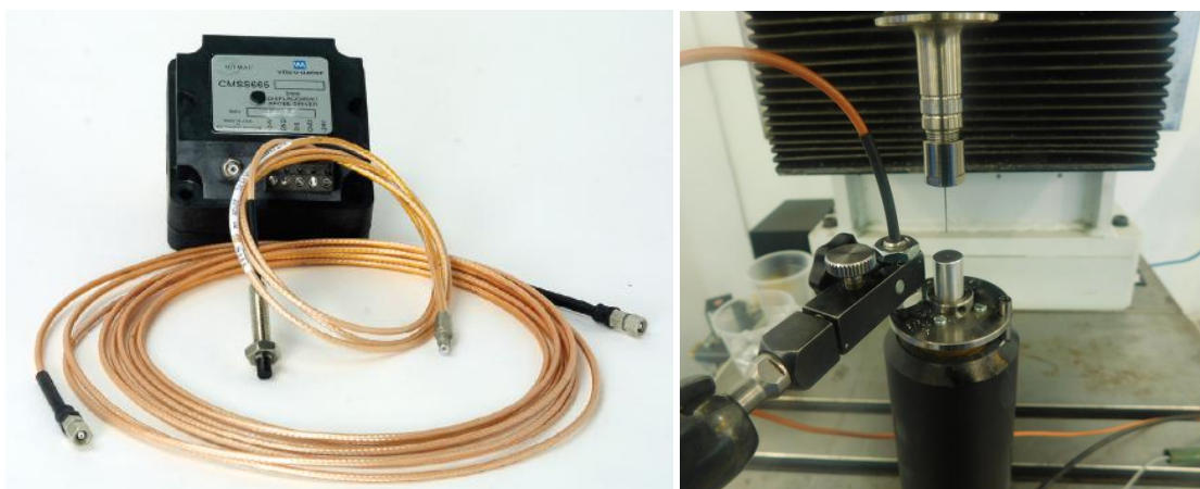
Slika 4.14 Senzor vibracija i mjesto ugradnje u eksperimentalnom postavu
