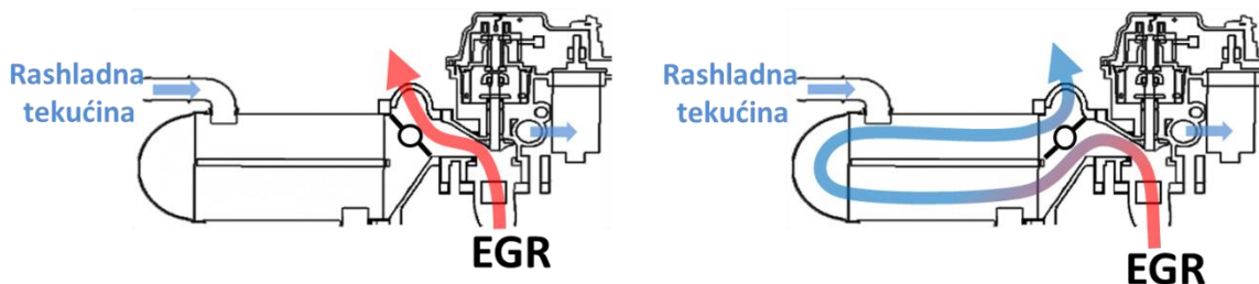
Slika 2.31. Sustav za povrat ispušnih plinova s izmjenjivačem topline
