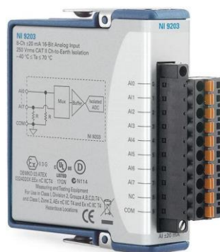
Slika 2.38. Modul NI 9203 za očitavanje jakosti struje [72]
