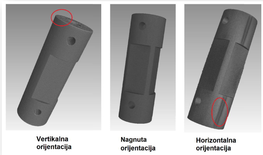
Slika 4-23. 3D modeli aluminijskog cilindra dobiveni rekonstrukcijom snimki skeniranja u različitim orijentacijama.
