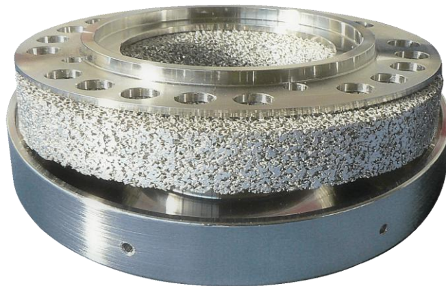
Slika 2.18 Separator ulja i zraka u mlaznom motoru [106]
