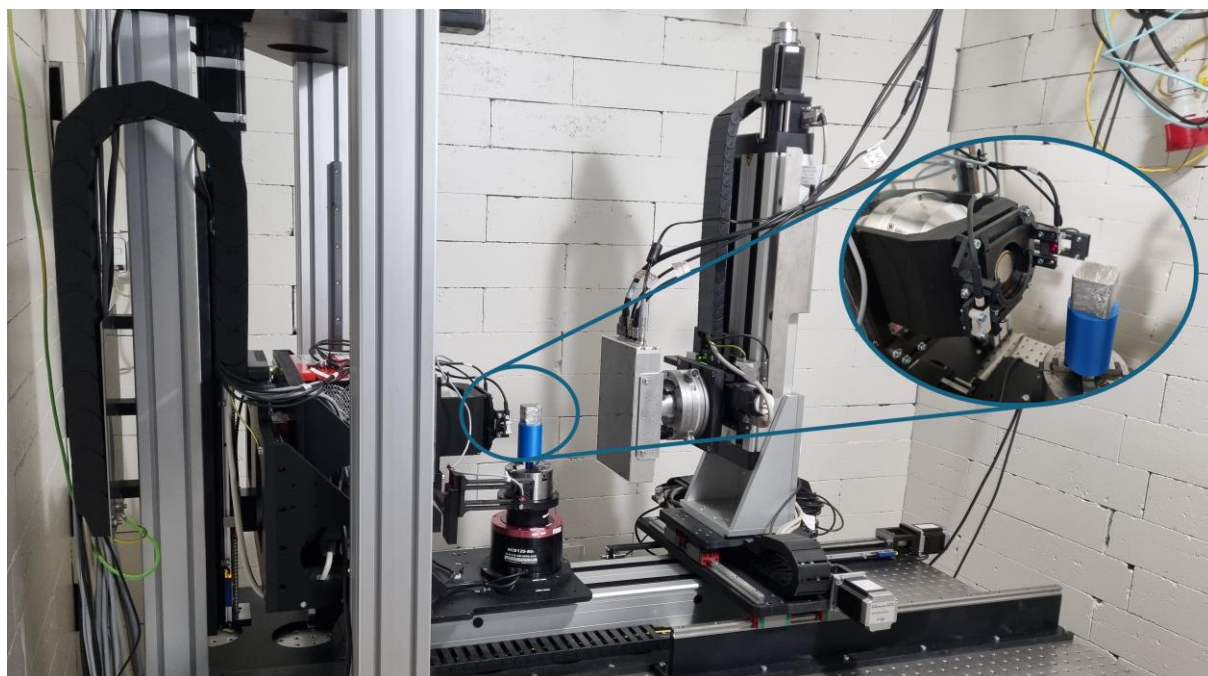
Slika 3.21 Uređaj za računalnu tomografiju s uvećanim prikazom položaja uzorka
