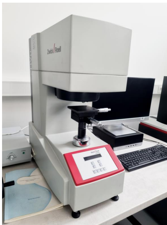
Slika 3.24 Uređaj za ispitivanje tvrdoće Vickersovom metodom
