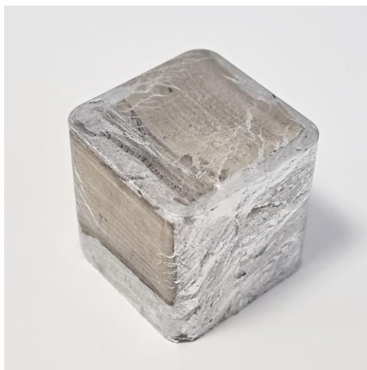
Slika 3.19 Uzorak aluminijeve pjene
