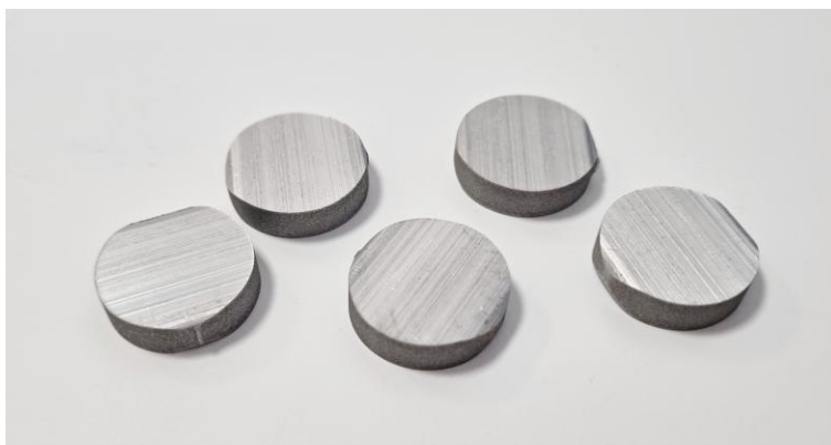
Slika 3.16 Uzorci za ispitivanje ekspanzije
