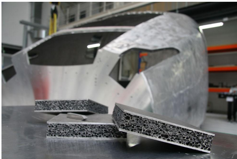
Slika 2.13 Prototip prednjeg dijela lokomotive izrađen od sendvič kompozita s jezgrom od aluminijske pjene [102]
