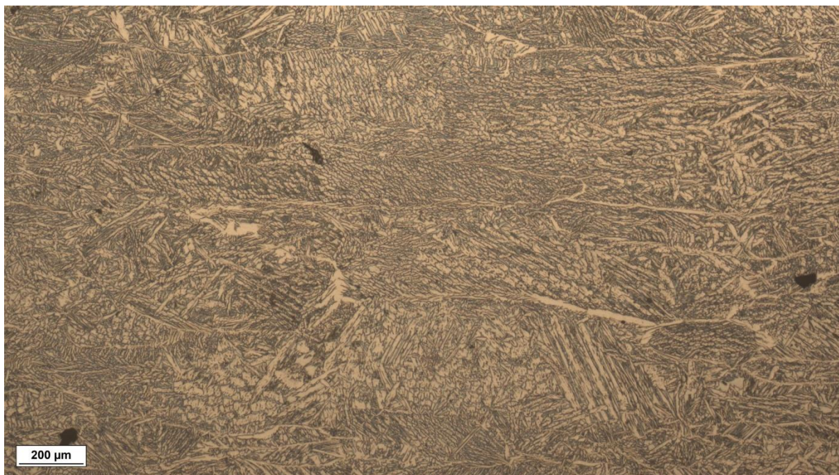
Mikrostruktura uzorka 2 nagriženog oksalnom kiselinom, povećanje 50×
