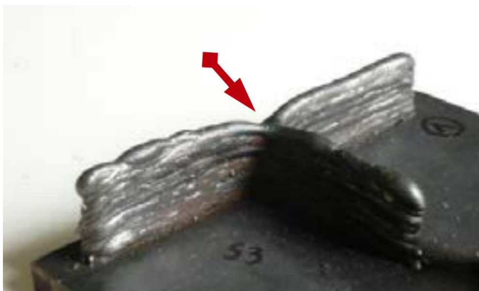
Slika 2. Primjer nepravilnosti uslijed neadekvatne putanje polaganja slojeva [43]
