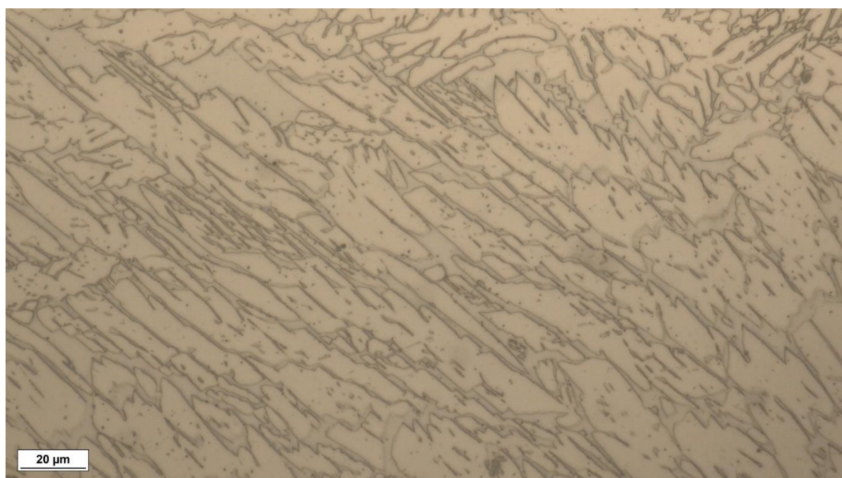
Mikrostruktura uzorka 2 nagriženog oksalnom kiselinom, povećanje 500×
