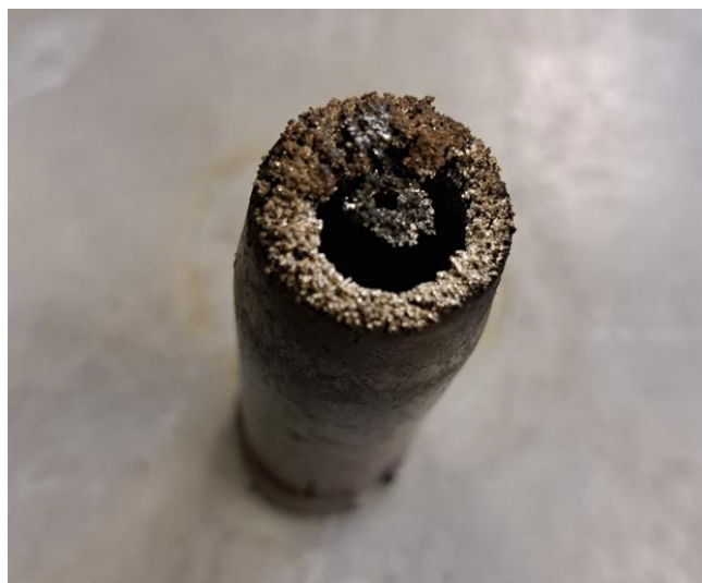
Slika 32. Onečišćenje plinske sapnice nalijepljenim kapljicama metala
