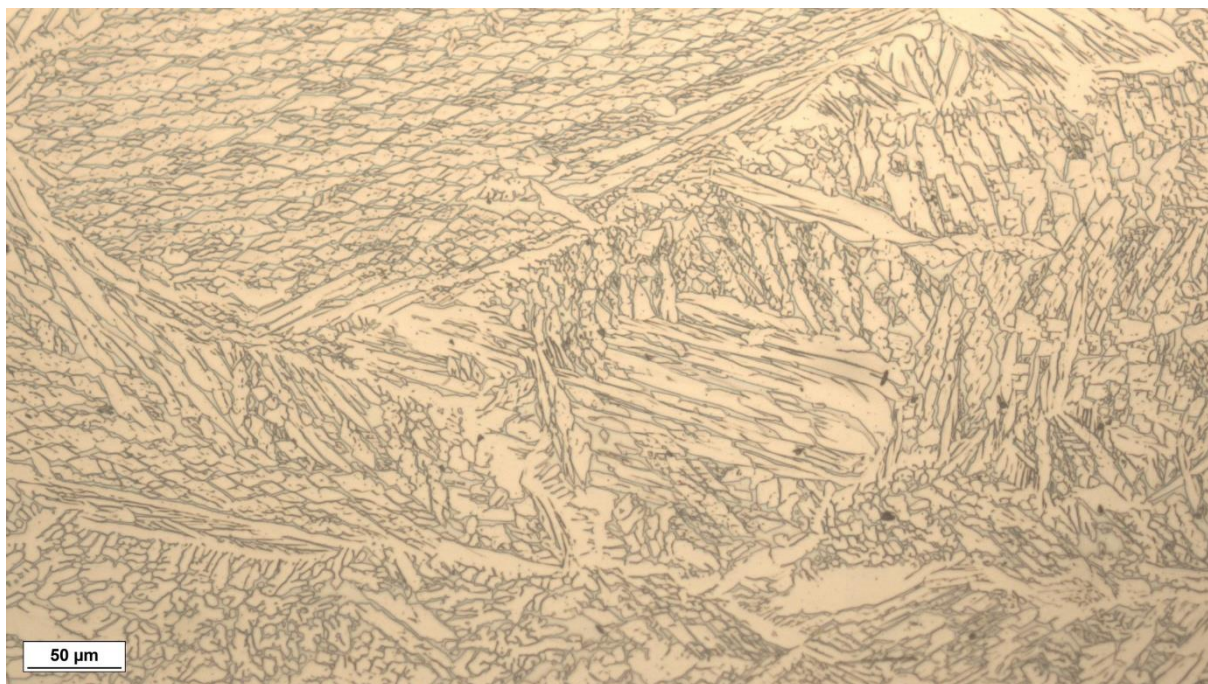
Mikrostruktura uzorka 3 nagriženog oksalnom kiselinom, povećanje 200×
