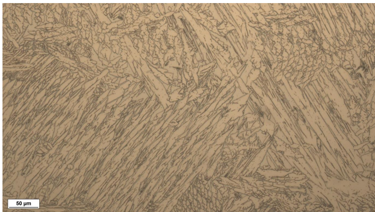
Slika 72. Karakteristična mikrostruktura za uzorak 4, povećanje 200×
