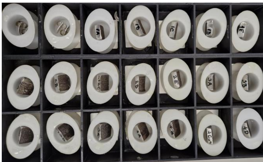
Slika 37. Segmenti uzoraka pripremljeni u kalupe prije zalijevanja epoksi-smolom
