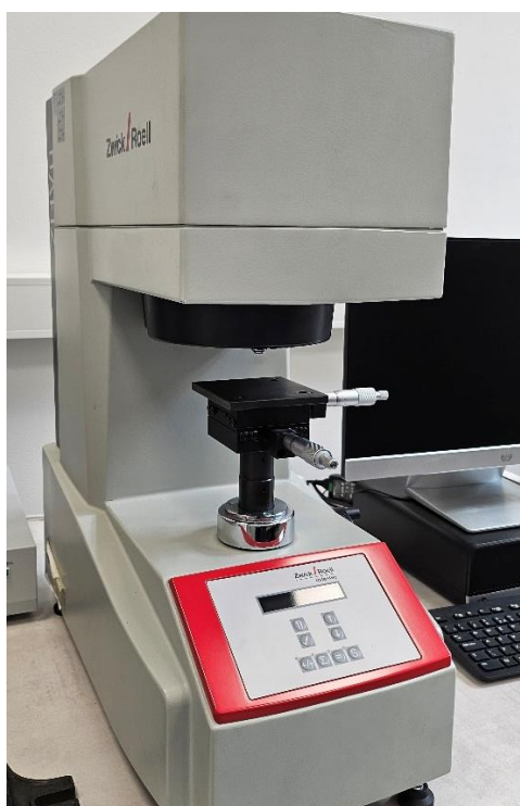
Slika 39. Tvrdomjer ZwickRoell Indentec ZHV \mu -ST
