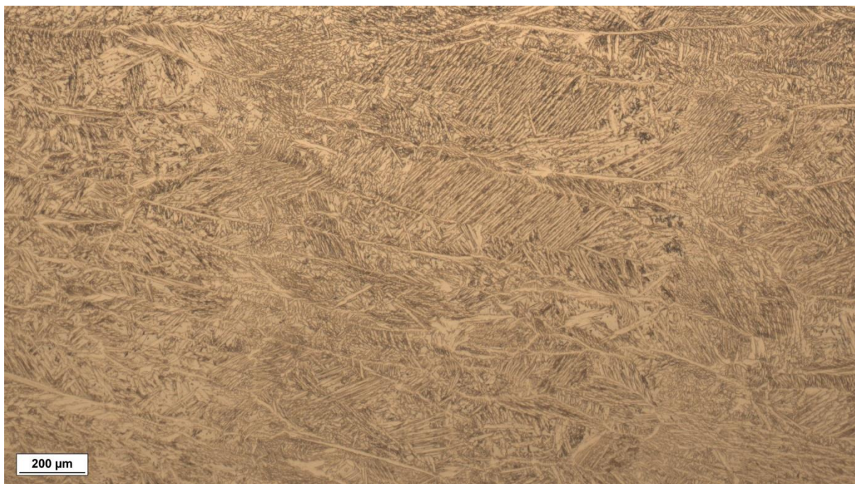
Mikrostruktura uzorka 4 nagriženog oksalnom kiselinom, povećanje 50×
