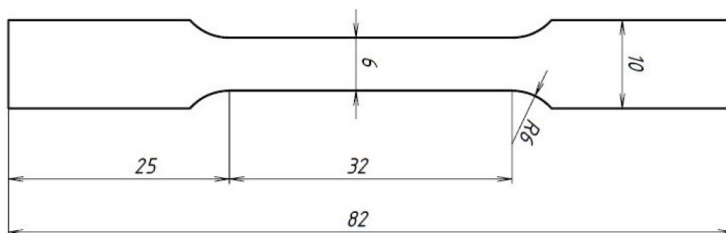
Slika 40. Tehnički crtež epruveta za statičko vlačno ispitivanje
