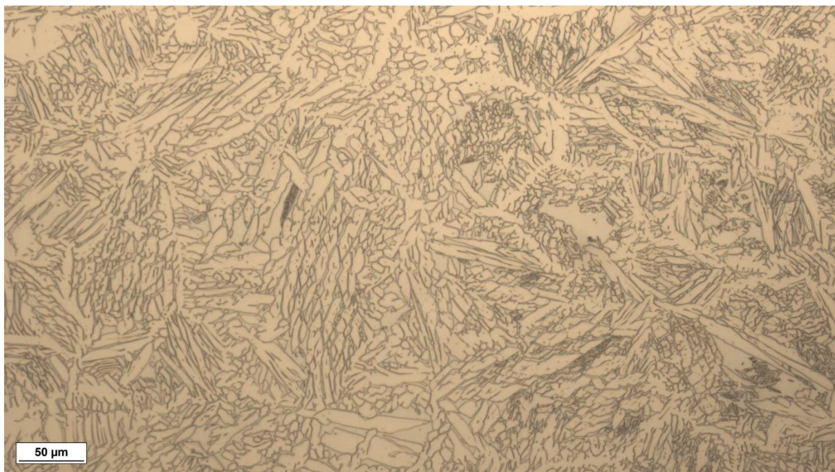
Mikrostruktura uzorka 1 nagriženog oksalnom kiselinom, povećanje 200×
