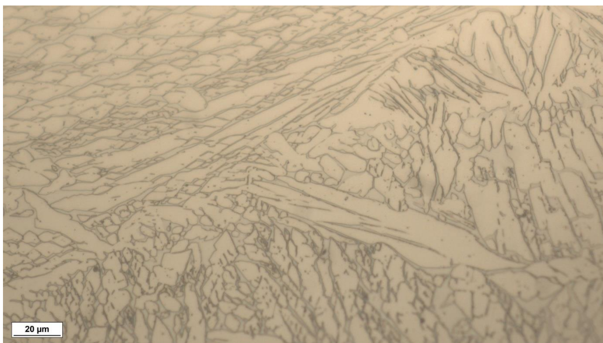
Mikrostruktura uzorka 3 nagriženog oksalnom kiselinom, povećanje 500×
