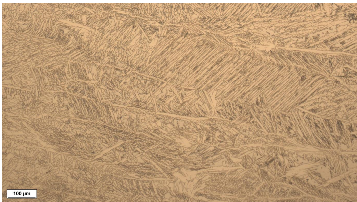
Mikrostruktura uzorka 4 nagriženog oksalnom kiselinom, povećanje 100×
