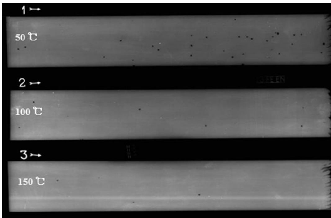
Slika 13. Radiografski prikaz utjecaja međuprolazne temperature na poroznost [65]
