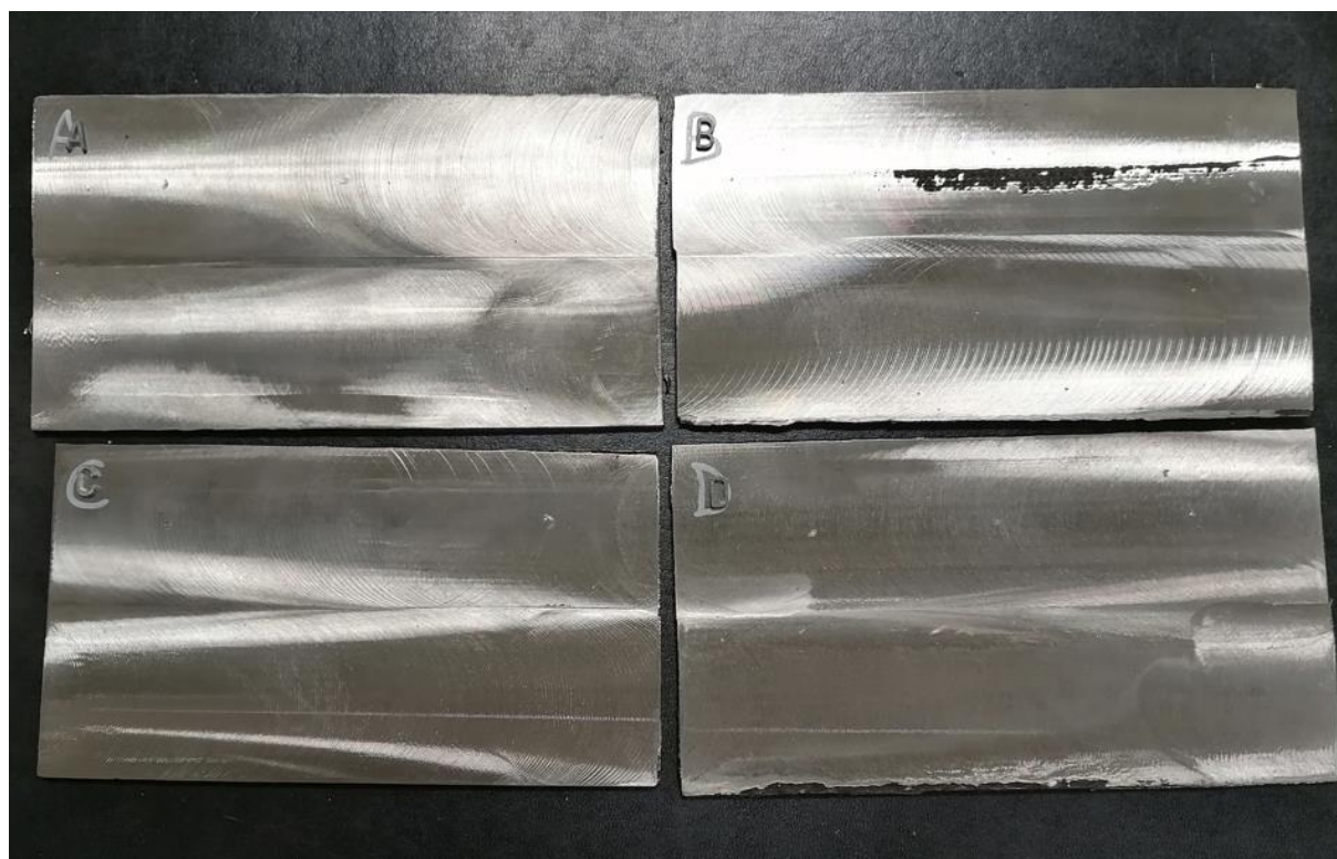
Slika 35. Ravni dijelovi uzoraka pripremljeni za radiografsko snimanje
