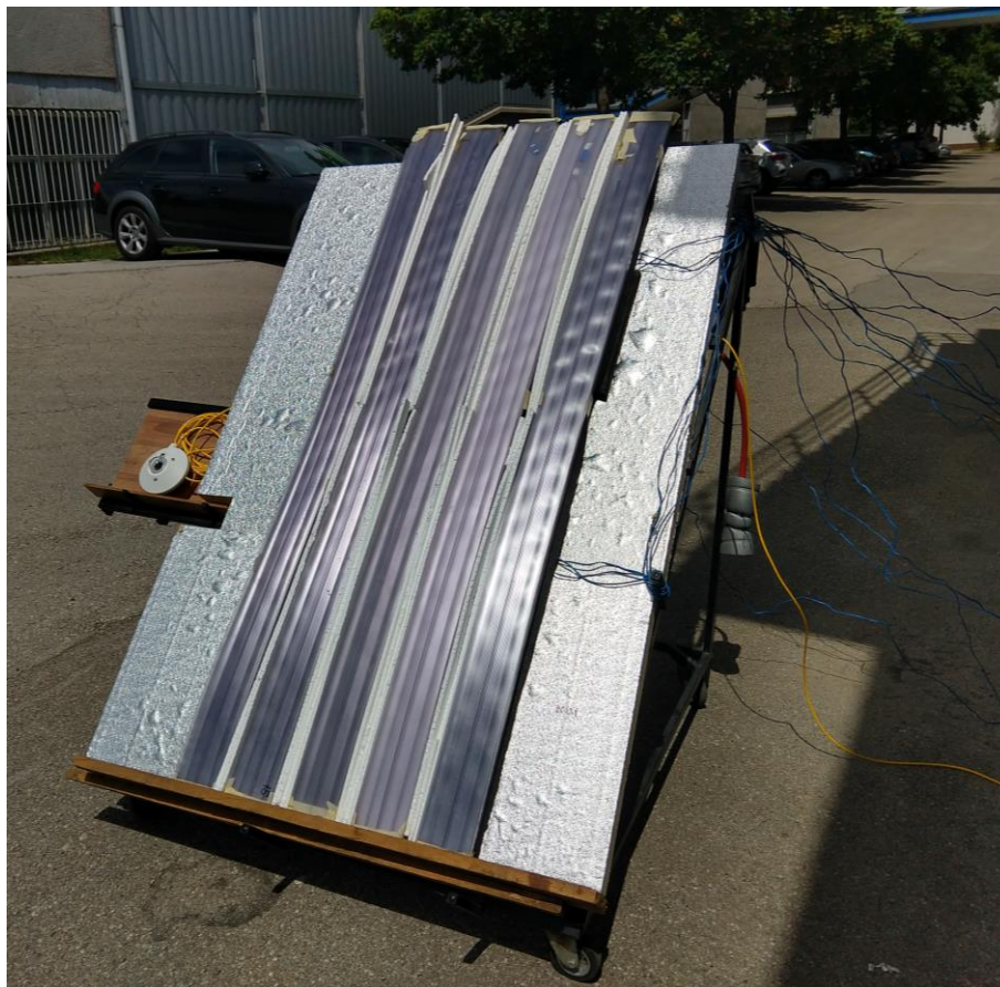
Slika 24 Fotografija dijela mjerne linije tijekom provedbe ispitivanja, prototip postavljen samostalno s boljom izolacijom rubova, rujan 2021.
