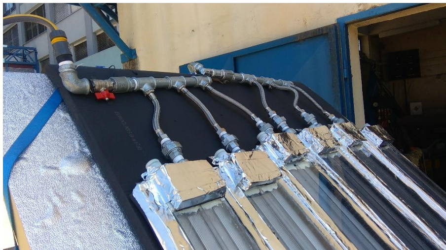
Slika 20 Fotografija Prototipa 2, prikaz načina spajanja prototipa na mjernu liniju
