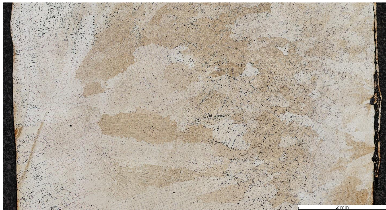
Slika 7.33 Skupna snimka poprečnog presjeka gornje zone odljevka P3
