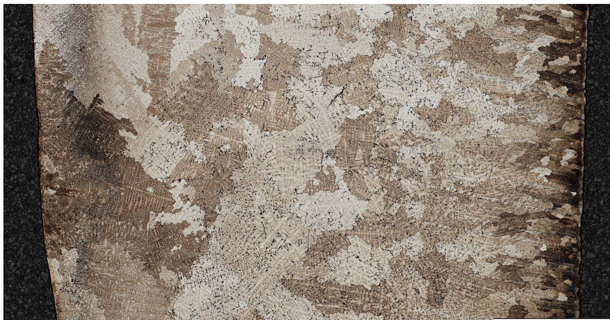
Slika 0.14. Skupna snimka poprečnog presjeka gornje zone uzorka P2
