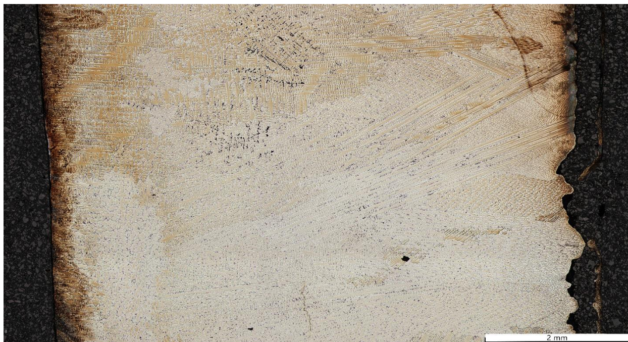
Slika 7.35 Skupna snimka poprečnog presjeka donje zone odljevka P3
