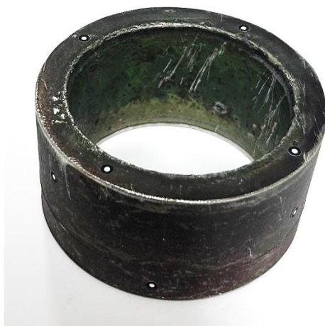
Slika 7.6 Izometrijski pogled na odljevak P3, neposredno nakon lijevanja
