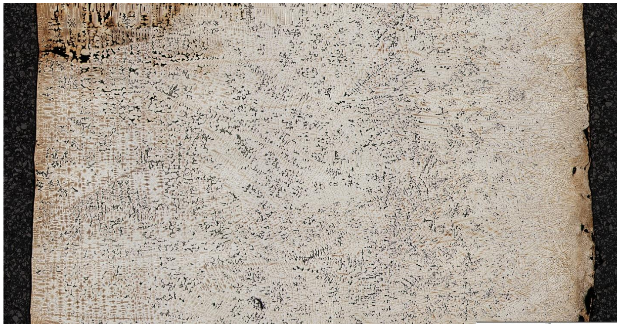
Slika 0.21. Skupna snimka poprečnog presjeka srednje zone uzorka P5
