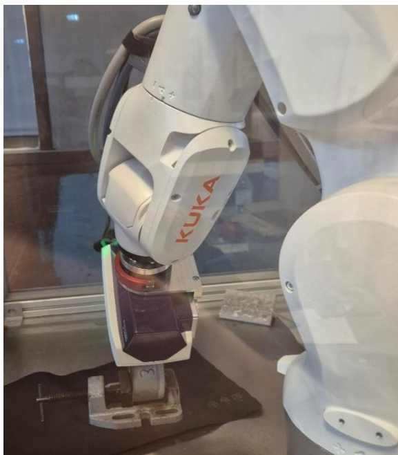
Slika 6.18 Uređaj Pulstec \mu – X360s s robotskom rukom KUKA pri mjerenju zaostalih napreznja
