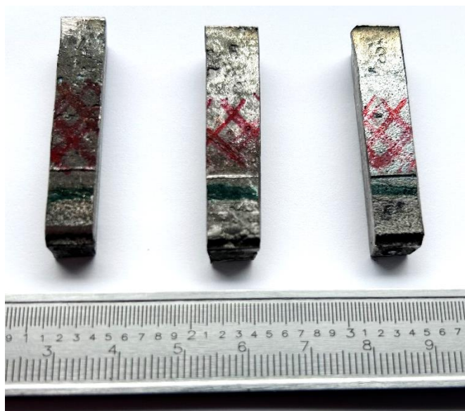
Slika 6.6 Prikaz uzoraka P3 – P5 dobivenih rezanjem odljevaka za DSC analizu
