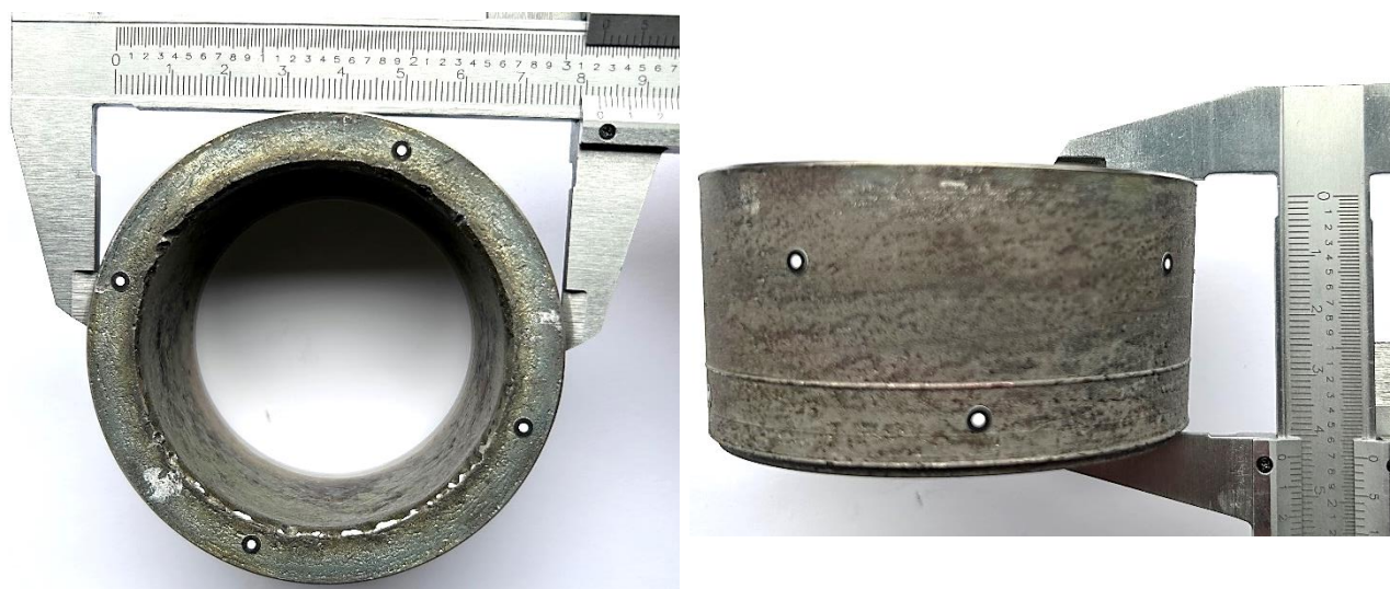
Slika 7.7 Prednji i gornji pogled na odljevak P3 s prikazom mjerenja dimenzija
