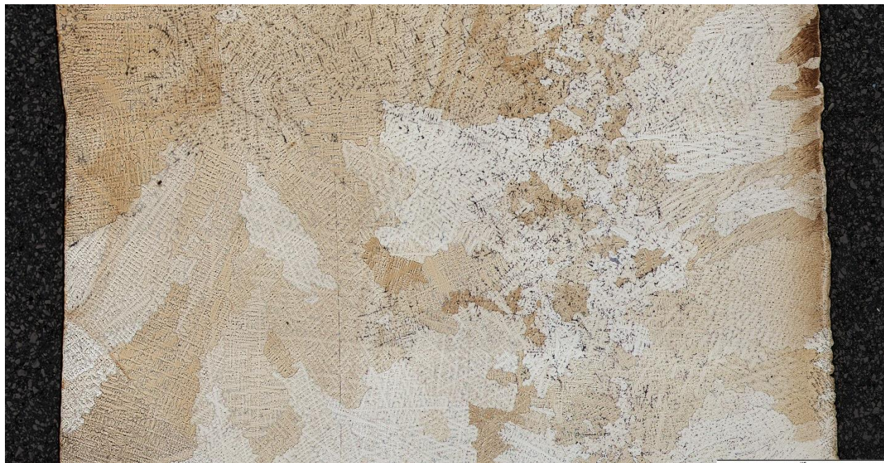
Slika 0.13. Skupna snimka poprečnog presjeka donje zone uzorka P1
