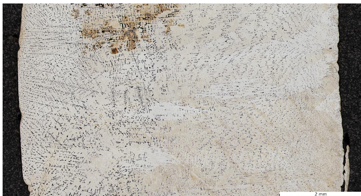
Slika 7.34 Skupna snimka poprečnog presjeka srednje zone odljevka P3
