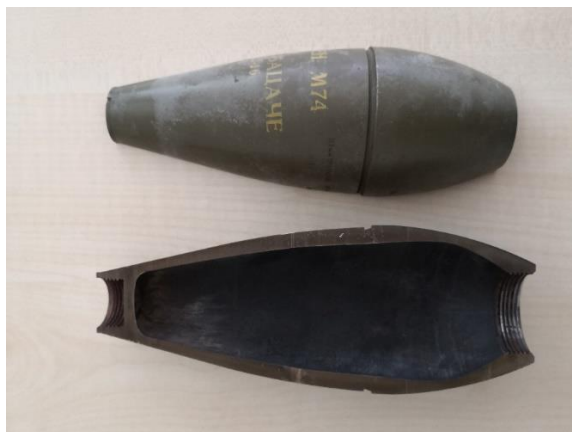
Slika 2.7. Izvorni oblik ispitnog uzorka s vidljivom unutarnjom geometrijom
