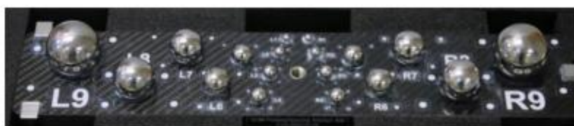
Slika 3.4. VDI/VDE 2634 kompatibilni artefakt [68]
