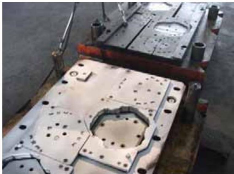
Slika 2.3. GD&T inspekcija čeličnog kalupa [16]
