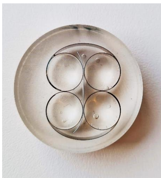
Slika 3.8 Ispolirani uzorak višeslojnoga plastičnog otpada u epoksidnoj smoli
