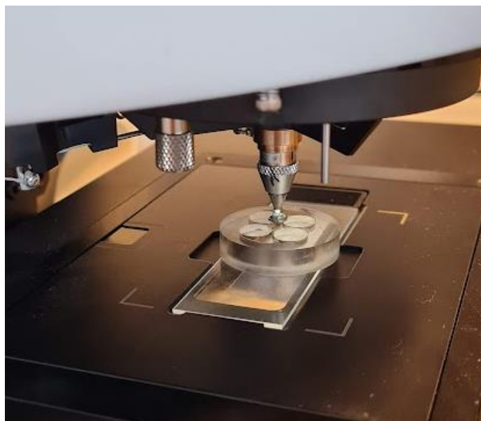
Slika 3.12 ATR snimanje uzorka PerkinElmer Spectrum Two spektrofotometrom s mikroskopom
